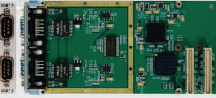
Модуль KPMC102-23 предназначен для обеспечения интерфейса Ethernet 10/100BaseT.
