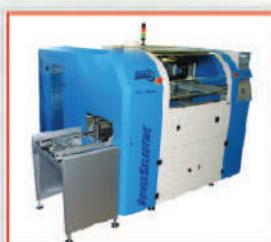
Отмывка печатных плат производится с помощью установки MINICLEAN фирмы PB (Чехия).
