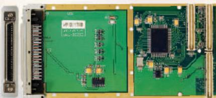
Модуль KPMC100 предназначен для обеспечения интерфейса SCSI-2.
