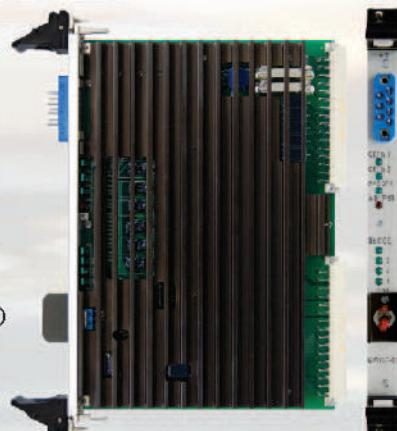
Модуль поддержки питания МПП предназначен для обеспечения электропитанием модуля источника питания серии MPV-DC при пропадании основного первичного напряжения.
