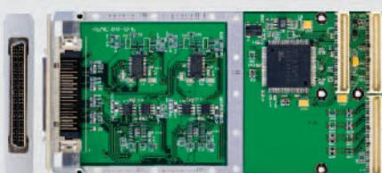
Модуль KPMC106 предназначен для обеспечения интерфейса RS232/422.
