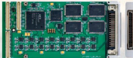
Модуль KPMC109 предназначен для обеспечения интерфейса CAN.
