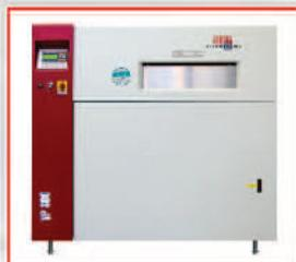
Пайка SMD-компонентов может также выполняться системой парофазной пайки VP-800 фирмы ASSCON (Германия).
