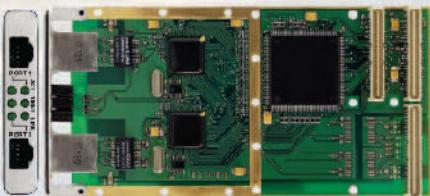
Модуль KPMC102 предназначен для обеспечения интерфейса Ethernet 10/100BaseT.
